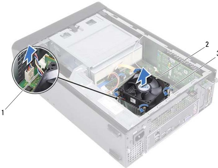
1 Cable del ventilador del procesador
